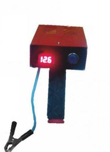
Предназначена для проверки аккумуляторных батарей под нагрузкой
